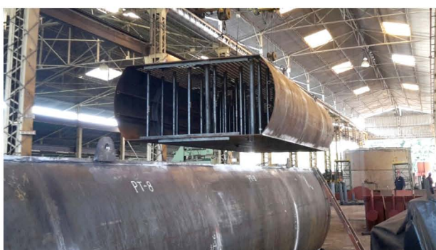
Sistema de ocho filtros de mangas totalmente automatizado para dos calderas, fabricado y montado por COIN para la Industria Cervecería de Colombia.
