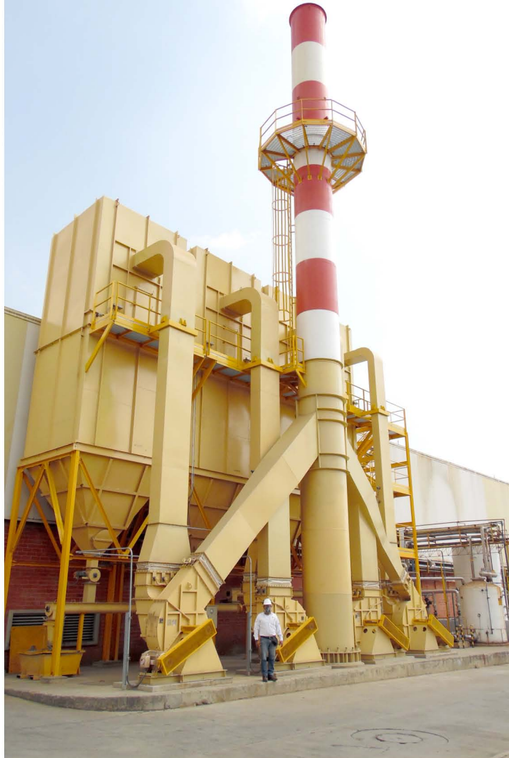
Sistema colector de emisiones de óxido de plomo, diseñado y fabricado por COIN para fábrica de baterías en Colombia.
