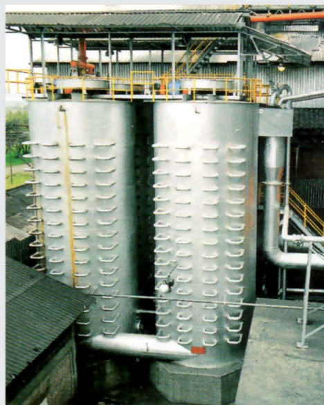
Cristalizadores verticales fabricados por COIN con Licencia Fives Cail-Fives Fletcher
