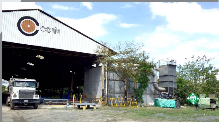
Vista parcial de la planta de fabricación de COIN en Cali, que muestra su cabina de sandblasting con su sistema colector de polvo, para aplicación de pinturas especiales en equipos pesados hasta de 5mts. ancho x 6mts. largo x 6mts. de altura.
