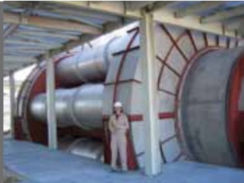
Secador-enfriador multitubular de 80 tah - TURQUÍA
